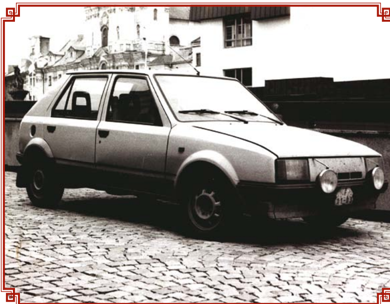
Tzv. opravný prototyp Škoda 781 (1983–1984) s motorem vpředu a pohonem předních kol. Sloužil jako nosič konstrukčních prvků a částí příštího vozu
